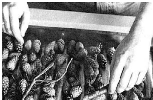
Slika 19. i 19a. Čišćenje grančica i drugih krupnijih nečistoća vrši se ručno na separatoru sa rotirajućim valjcima, zatim odlazi u ekstraktor semena
