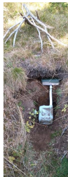
Слика 15.2-15.3. Уграђен гравитационог лизиметра у чело земљишног профила
