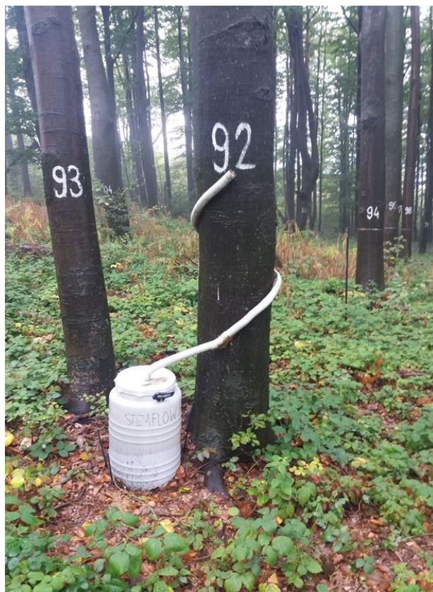
Слика 14.2. „Stemflow“ колектор на огледном пољу, БИТ Ниво 2, Црни врх 2019. година Figure 14.2. `Stemflow` collector on Crni Vrh Level II sample plot, 2019
