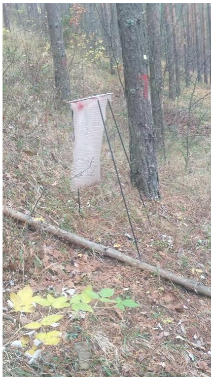
Слика 13.1. Колектор за сакупљање четина – лисног опада БИТ Ниво II – Мокра Гора Figure 13.1. Litterfall collector, Level II SP, Mokra Gora
