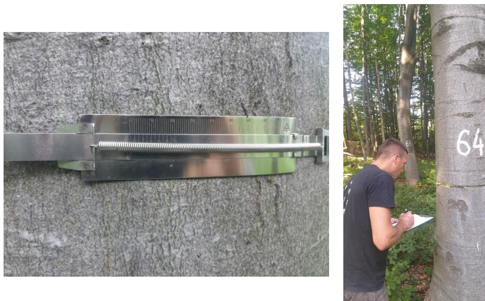
Слика 18.3-18.4. Мерење пречника стабла на механичком дендрометру Figures 18.3-18.4. Tree diameter measurement using a mechanical dendrometer
