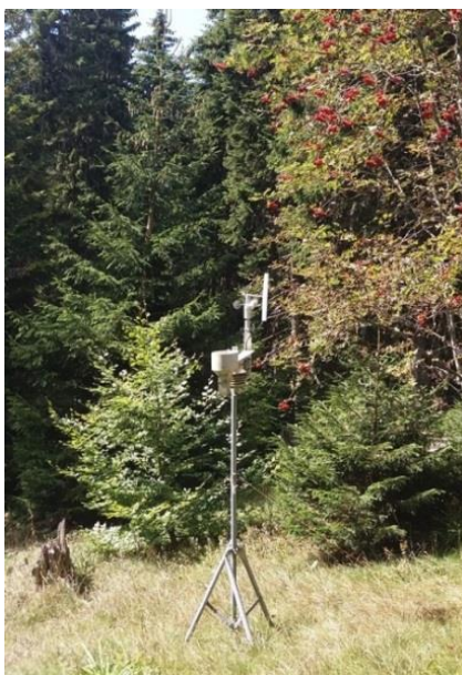
Слика 19.2. Метеоролошка станица за аутоматска мерења микроклиматских услова, Огледно поље Ниво-а 2, Копаоник
