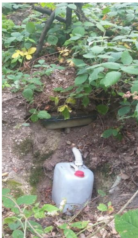
Слика 15.4. Инсталиран лизиметар са колектором за земљишни раствор, Огледно поље БИТ НИВО II – Црни Врх
