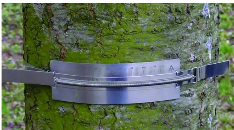
Слика 26.2. Мануелни дендрометар Figure 26.2. Manual dendrometer
