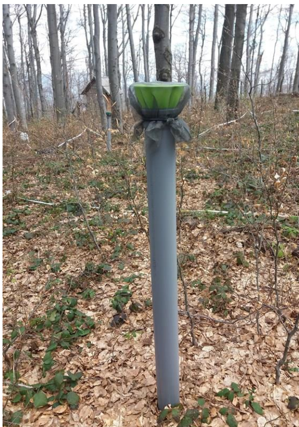
Слика 14.1. „Throughfall“ колектор на огледном пољу, БИТ Ниво 2, Црни врх, 2019. година Figure 14.1. `Throughfall` collector on Crni Vrh Level II sample plot, 2019
