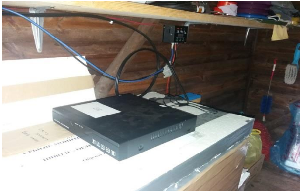
Слика 12.21. Снимач и контролни уређај напона струје за камеру, Мај 2019
