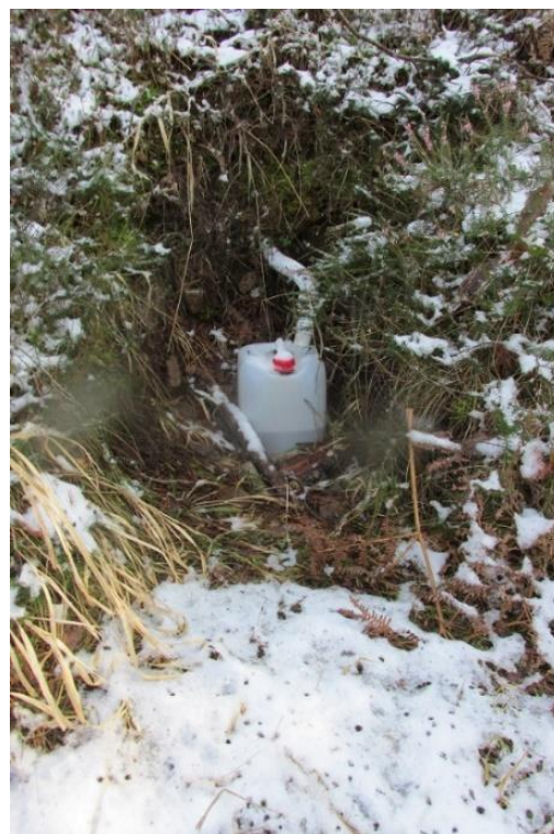
Слика 15.5. Инсталиран лизиметар са колектором за земљишни раствор Огледно поље БИТ НИВО II – Мокра Гора
