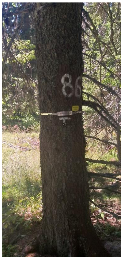
Слика 18.1-18.2. Мерење пречника стабла на механичком дендрометру Figures 18.1-18.2. Tree diameter measurement, a mechanical dendrometer setting and checking
