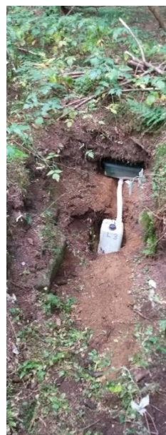
Слика 15.2-15.3. Уграђен гравитационог лизиметра у чело земљишног профила
