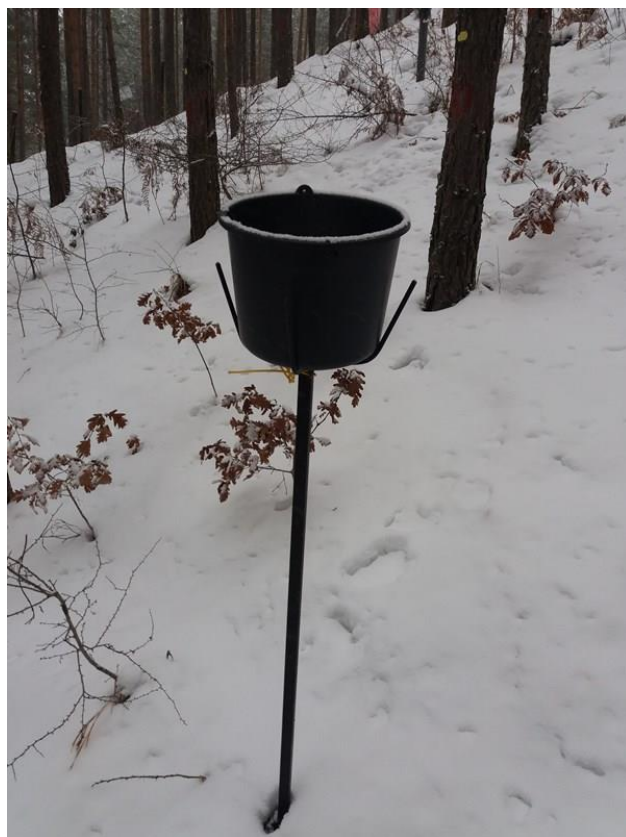
Слика 14.3. Колектор за снег на огледном пољу, БИТ Ниво 2, Мокра гора 2019. година Figure 14.3. `Bulk` snow collector on Mokra Gora Level II sample plot, 2019
