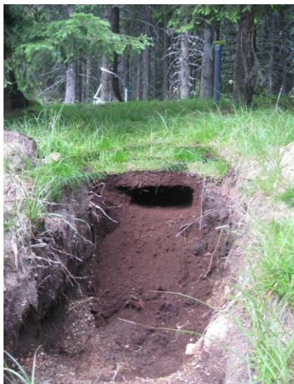
Слика 41. Припрема земљишног профила за инсталацију гравитационог лизиметра Огледно поље БИТ НИВО 2 Копаноник
