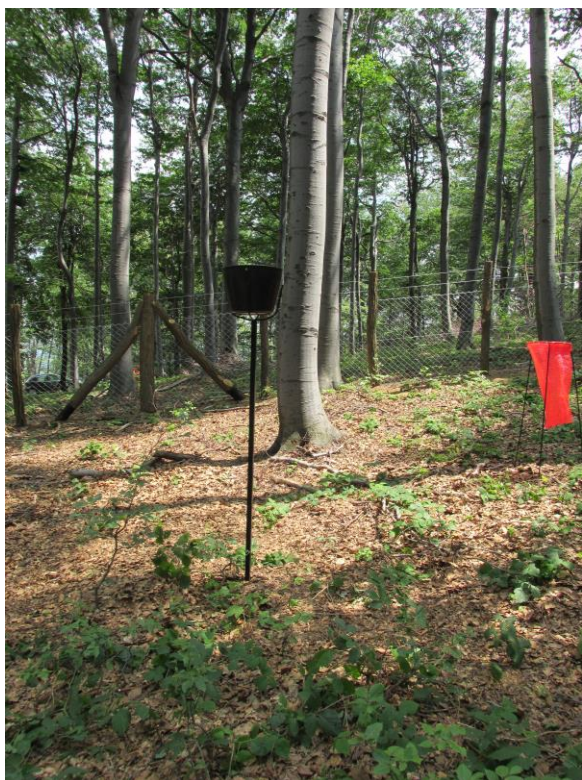
Слика 37. „Bulk“ колектор на огледном пољу, БИТ Ниво 2, Црни врх
