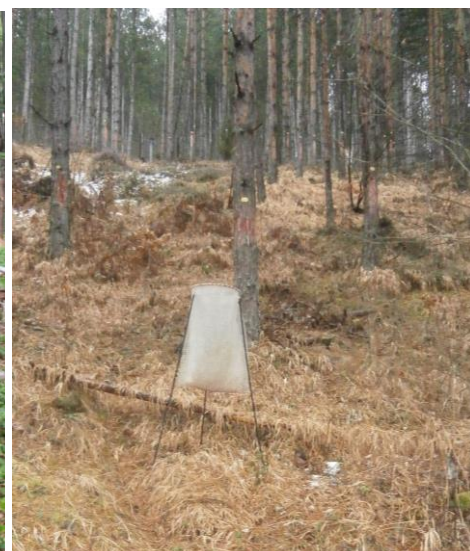
Слика 31. Колектор за сакупљање четина – лисног опада БИТ Ниво 2, Мокра Гора
