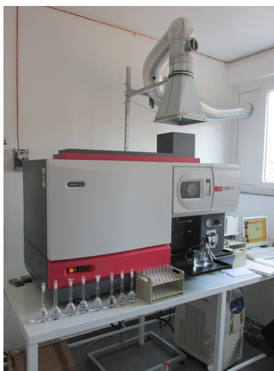
Слика 32. Одређивање количине хранљивих материја у лисном опаду (биланс кружења хранљивих материја у екосистему) за Копаоник, Црни врх и Мокру Гору Новоинсталирани ICP – AES Spectrometer у лабораторији Института за шумарство, Београд
