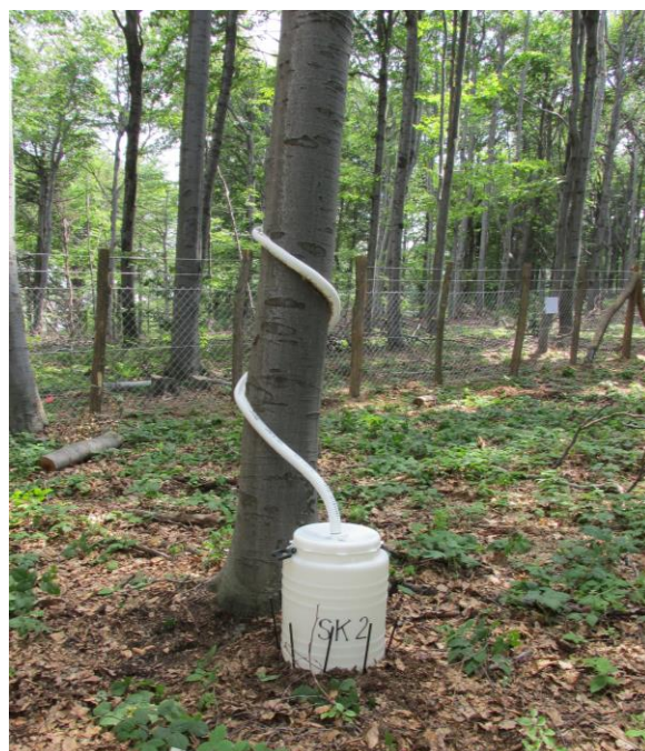
Слика 36. „Stemflow колектор“ на огледном пољу, БИТ Ниво 2, Црни врх
