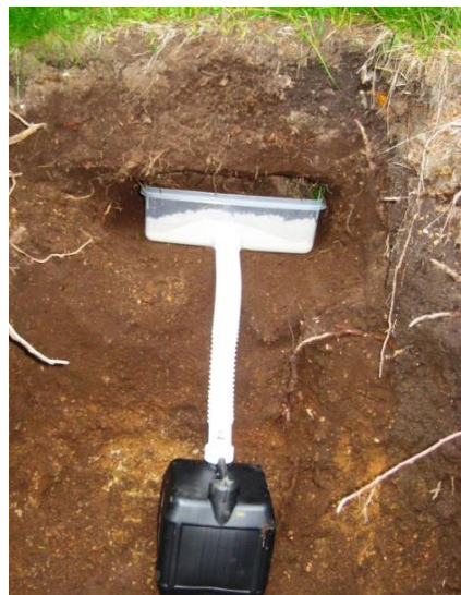
Слика 42. Инсталиран лизиметар са колектором за земљишни раствор на дубини~ 25цм (Ориг.) Огледно поље БИТ НИВО 2 Копаноник
