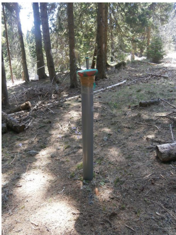
Слика 33. „Throughfall“ колектор на огледном пољу, БИТ Ниво 2, Копоник
