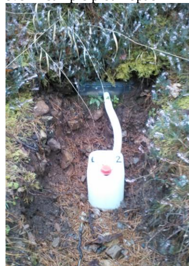
Слика 44. Инсталиран лизиметар са колектором за земљишни раствор Огледно поље БИТ НИВО 2 - Мокра Гора
