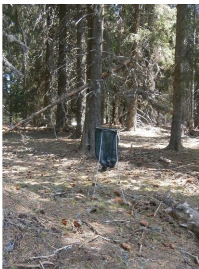
Слика 29. Колектор за сакупљање четина – лисног опада БИТ Ниво 2, Копаоник
