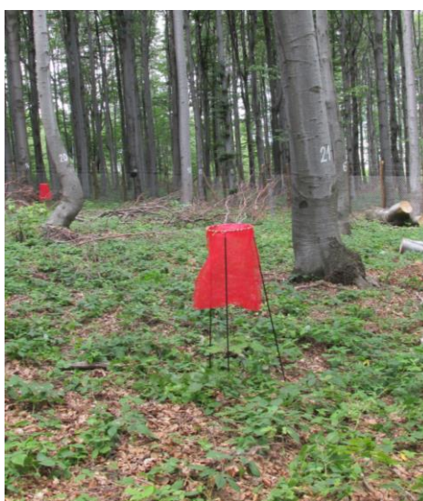
Слика 30. Колектор за сакупљање лисног опада БИТ Ниво 2, Црни врх
