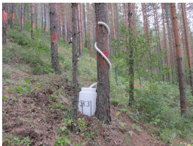
Слика 40. „Stemflow колектор“ на огледном пољу, БИТ Ниво 2, Мокра Гора
