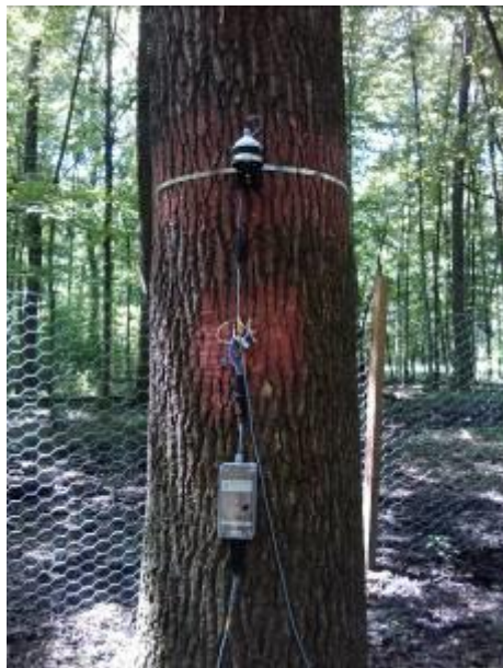
Слика 59. Постављање електронског дендрометра.
