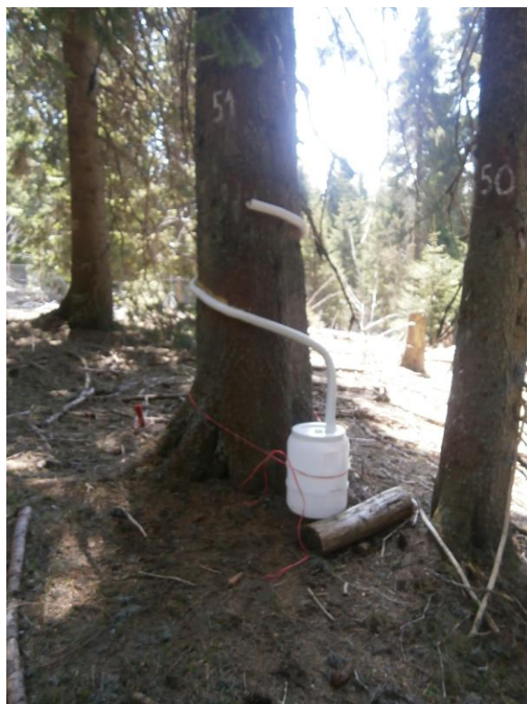
Слика 34. „Stemflow колектор“ на огледном пољу, БИТ Ниво 2, Копоник
