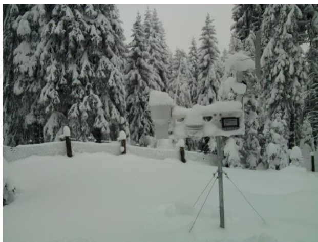
Слика 54. Метеоролошка станица за аутоматска мерења микроклиматских услова, Огледно поље Нивоа 2, Копаоник
