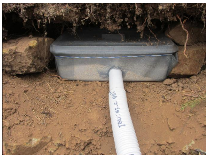
Слика 43. Инсталиран лизиметар са колектором за земљишни раствор Огледно поље БИТ НИВО 2 - Црни врх
