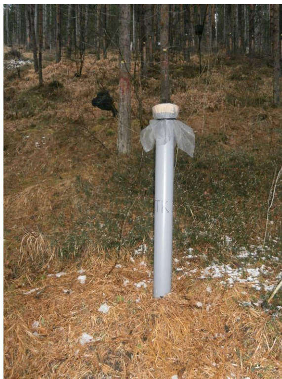
Слика 38. „Throughfall“ колектор на огледном пољу, БИТ Ниво 2, Мокра Гора
